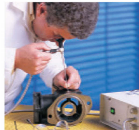
ミニリジッドスコープによるエアブリーキコンプレッサーの検査
