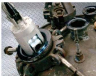
ø100mm ノズルを通し容器内部を検査
