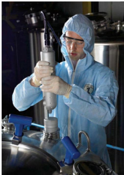
76mm ノズルを通し容器内部を検査
