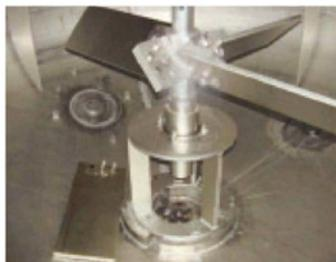
攪拌装置内で破損ボルトにより外れた
