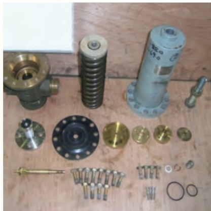
減圧弁分解修理
