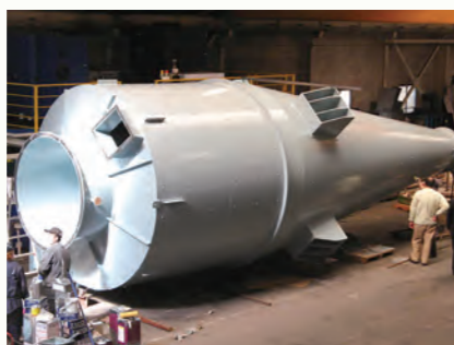
直径4m超の大型サイクロン
