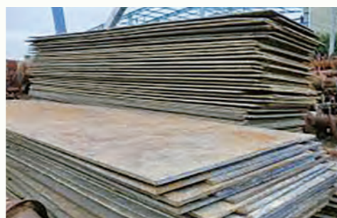
敷鉄板 工事侵入道路、仮設用道路 軟弱地盤覆工 作業場養生、重機作業など
