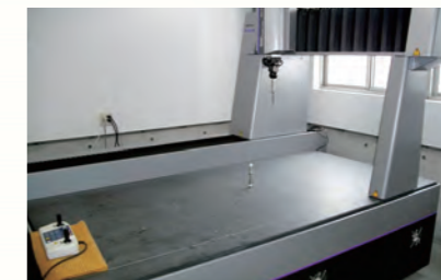
三次元計測による寸法検査
