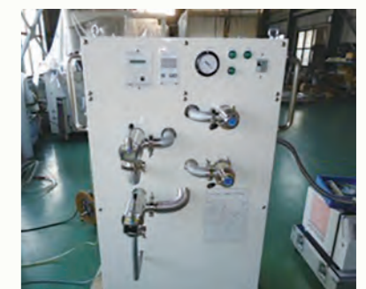
真空ポンプユニット
