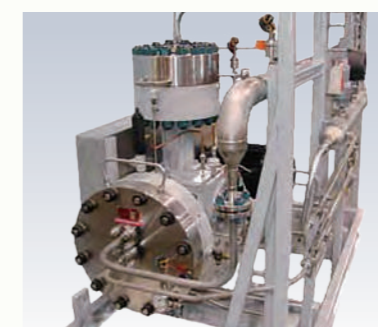
ダイヤフラムコンプレッサー
